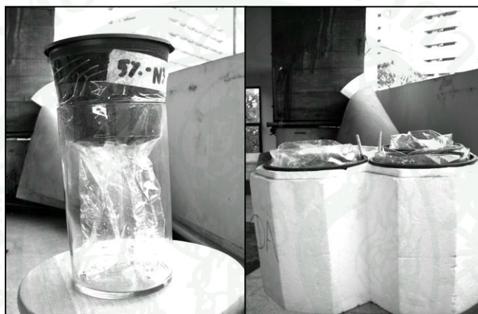
ภาพที่ 12 การเก็บน้ำชะจากกระถางทดลอง
