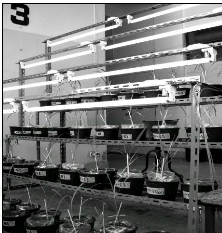
ภาพที่ 13 ชั้นวางกระถาง และลักษณะการติดตั้งหลอดไฟ
