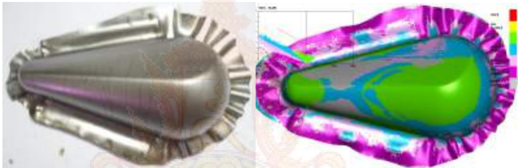
ภาพที่ ค.23 เปรียบเทียบชิ้นงานจริงกับ FEM , Trapenzifrom Drawbead, BHF 30 % , SPCD
