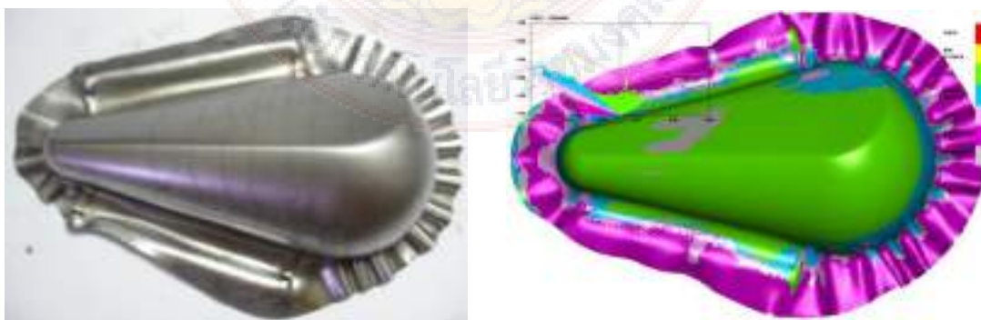
ภาพที่ ค.19 เปรียบเทียบชิ้นงานจริงกับ FEM , V-Shaped Drawbead, BHF 50 % , SPCD
