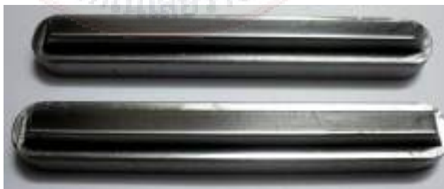
ภาพที่ 3.23 ดรอปิดแบบหน้าตัดสี่เหลี่ยมด้านไม่เท่า (Trapenzifrom Drawbead)
