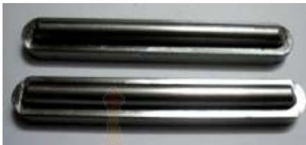
ภาพที่ 3.21 ดรอปิดแบบหน้าตัดครึ่งวงกลม (Haft-Round Drawbead)
