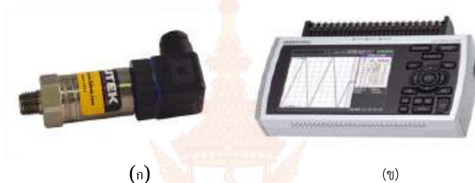
ภาพที่ 3.26 (ก) อุปกรณ์วัดแรงดันน้ำมัน (ข) อุปกรณ์จัดเก็บสัญญาณ
