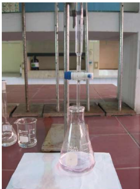
รูปที่ 3.3 การจัดอุปกรณ์สำหรับการไทเทรตหาปริมาณกรดไขมันอิสระ
