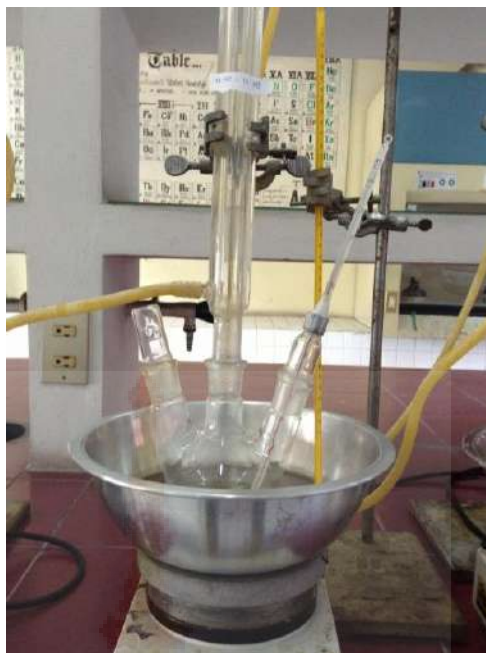
รูปที่ 3.4 การตั้งชุดรีฟลักซ์ในการทำปฏิกิริยาทรานส์เอสเทอริฟิเคชัน
