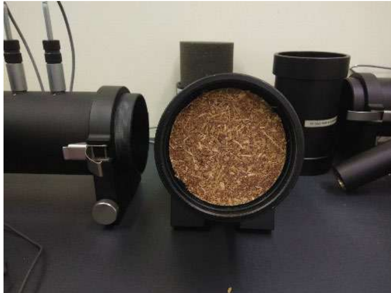
ภาพที่ 7 การทดสอบด้านการดูดซับเสียง แผ่นชิ้นงานที่ทดสอบ เส้นผ่าศูนย์กลาง 10 เซนติเมตร หนา 1 เซนติเมตร
