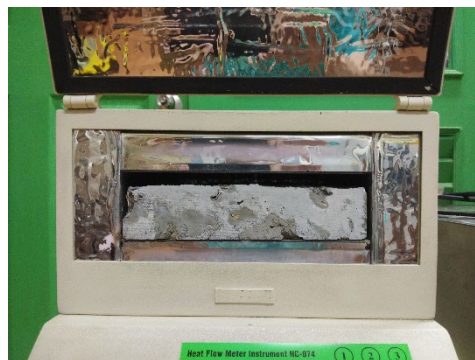
ภาพที่ 8 การทดสอบค่าการนำความร้อนโดยเครื่อง ASTM C518
