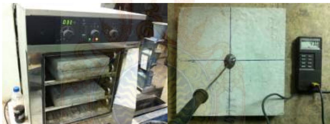
ภาพที่ 3.16 การทดสอบหาเวลาที่ทำให้แผ่นตัวอย่างมีอุณหภูมิเท่ากับอุณหภูมิปกติ
