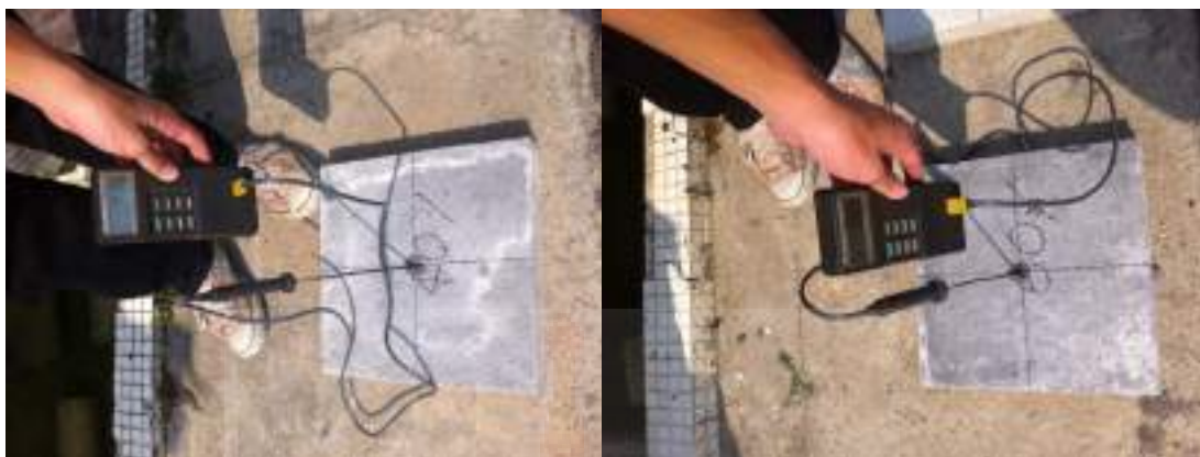
ภาพที่ 3.15 การทดสอบวัดค่าความร้อนจากแผ่นตัวอย่าง
