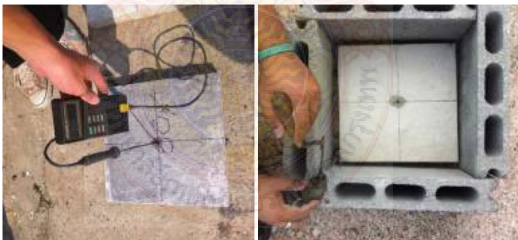
ภาพที่ 4.7 การทดสอบวัดอุณหภูมิของการสะสมความร้อน
