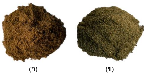
ภาพที่ 1 (ก) ขี้เลื่อยไม้สัก และ (ข) ผงใบมะกรูด ที่ผ่านการคัดขนาด
