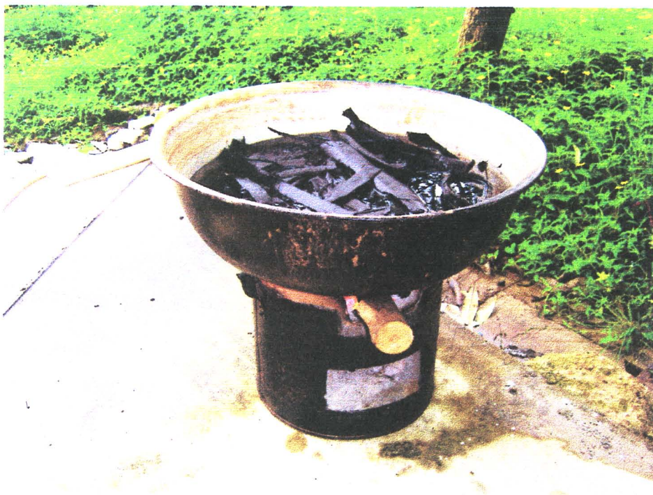
ภาพที่ 4.6 แสดงการต้มเปลือกต้นสอยดาวเพื่อให้ยางหมดและเส้นใยชุ่มน้ำ
