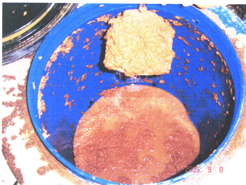
ภาพที่ 4.9 แสดงลักษณะเยื่อเปลือกต้นสอยควาที่ผ่านการบดแล้ว
