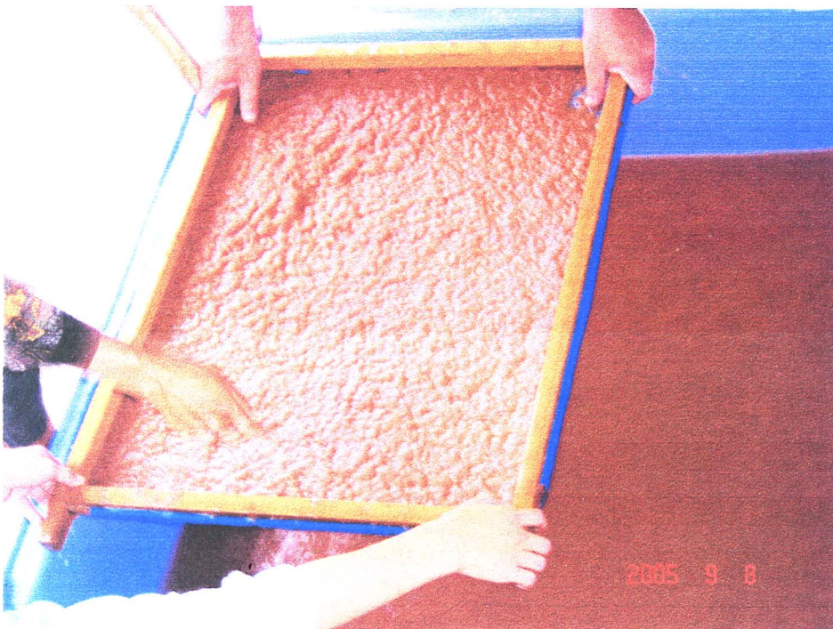
ภาพที่ 4.11 แสดงการนำตะแกรงแม่พิมพ์ชั้นเยื่อเพื่อทำแผ่นกระดาษ
