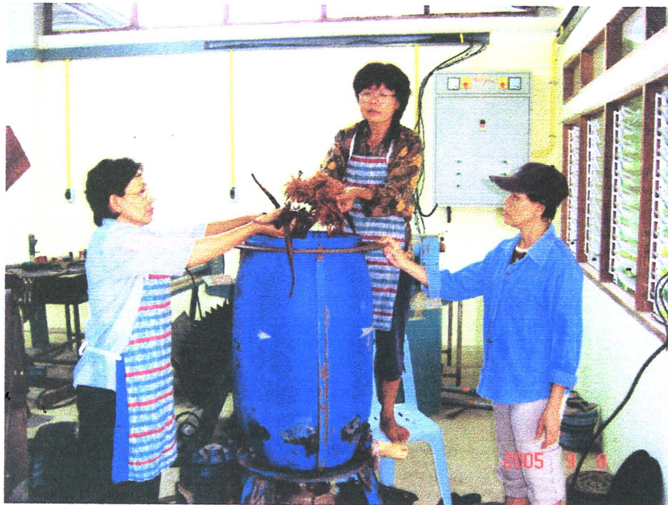
ภาพที่ 4.8 แสดงการนำเปลือกต้นสอยควาใส่เครื่องบดเพื่อทำการบดตีเยื่อ
