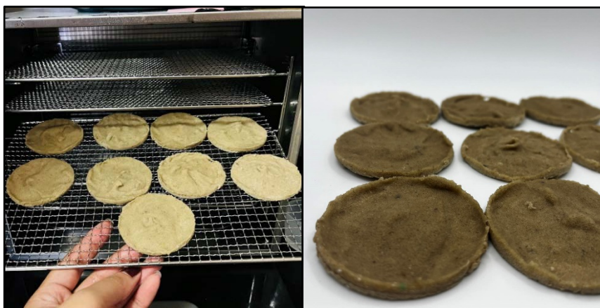
ภาพที่ 8 ภาพซ้าย คือ การแสดงรายละเอียดขั้นตอน ค. เข้าเครื่องอบลมร้อน (Hot Air Oven) และภาพขวา คือ ขั้นตอน ง. ที่แสดงลักษณะไบโอเรซินของสูตรที่ 13.9 ในรูปแบบแผ่น
