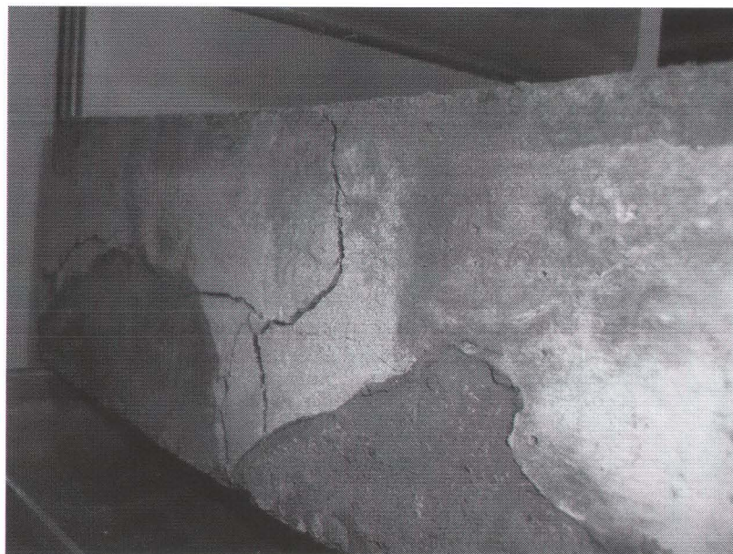
รูปที่ 4.8 การสูญเสียกำลังการยึดเหนี่ยวระหว่างจีโอโพลิเมอร์คอนกรีตต่อเหล็กเสริม
