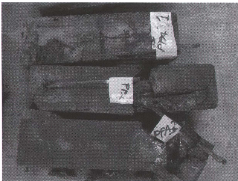
รูปที่ 4.4 การแตกร้าวของจีโอโพลิเมอร์คอนกรีตจากถ้ำลอย
