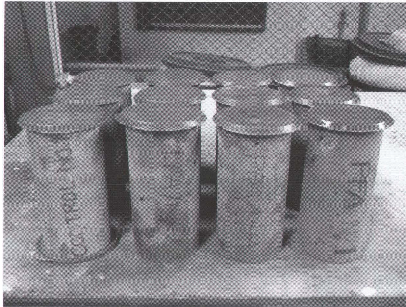
รูปที่ 3.20 วางตัวอย่างที่เคลือบผิวหน้าด้วยกัมมะถันให้แข็งตัวในอุณหภูมิปกติ
