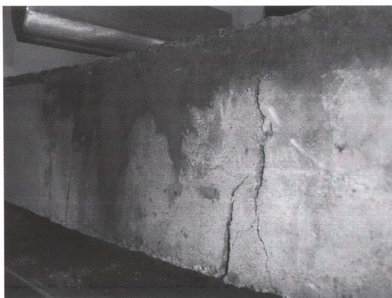
รูปที่ 3.24 รอยร้าวเนื่องจากการวิบัติของแท่งตัวอย่างทดสอบ
