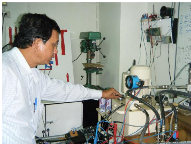
รูปที่ 4.17 การติดตั้งและประกอบชุดควบคุมการทำงานของเซอร์โวล์ว
