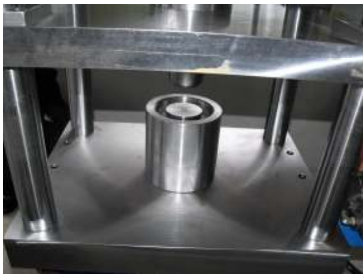
(ค) ตำแหน่งและการติดตั้งแม่พิมพ์ที่ใช้ในการกดอัดขึ้นรูป
