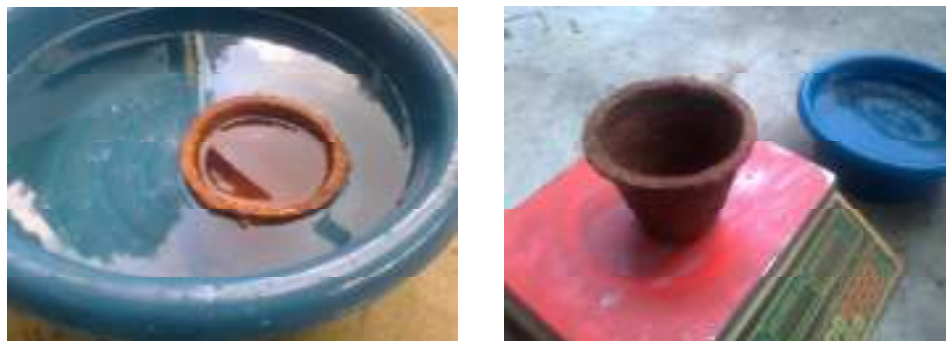
รูปที่ 4.16 การแช่กระถางลงในน้ำสะอาดและการชั่งน้ำหนักหลังการแช่น้ำเป็นเวลา 1 นาที
