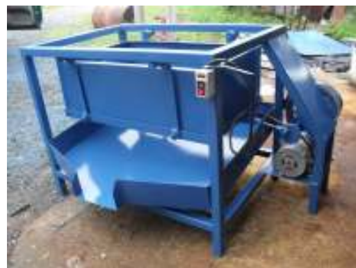
รูปที่ 3.31 เครื่องร่อนเพื่อคัดแยกขนาดของขุยมะพร้าว
