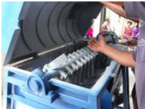
รูปที่ 3.27 โครงสร้างภายในถังตีของเครื่องตีกามมะพร้าว
