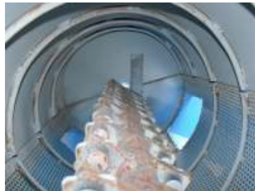
รูปที่ 3.27 โครงสร้างภายในถังตีของเครื่องตีกามมะพร้าว
