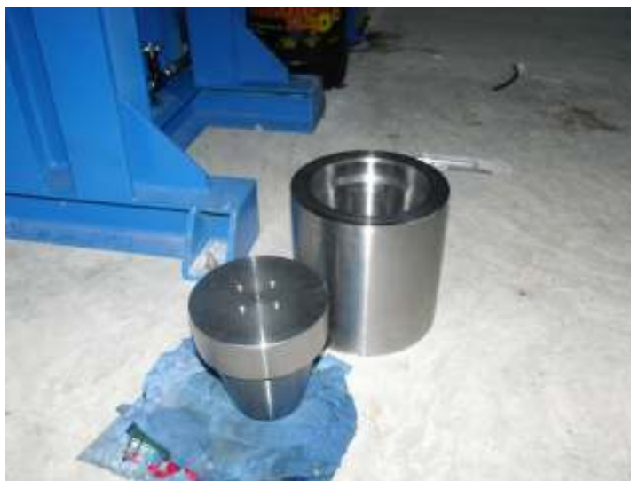
รูปที่ 3.19 แม่พิมพ์ที่ใช้ในการกดอัดขึ้นรูปกระถาง
