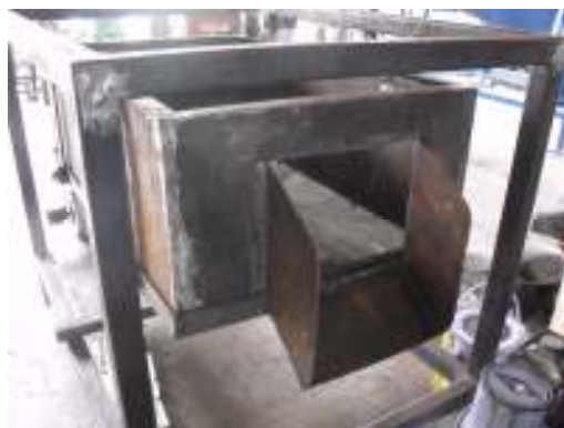
รูปที่ 3.31 เครื่องร่อนเพื่อคัดแยกขนาดของขุยมะพร้าว
