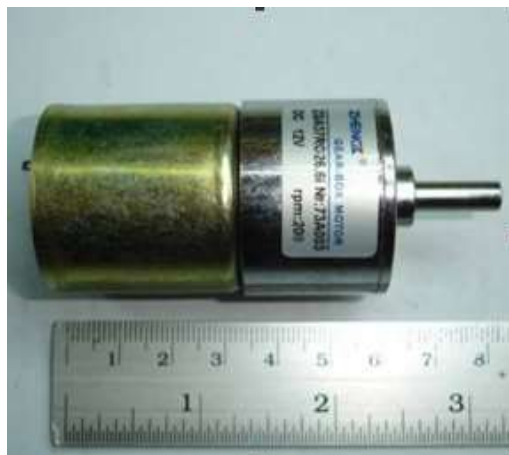
รูปที่ 3.15 มอเตอร์ที่ใช้กับชุดใบพัดกลับด้านและดักขนมโดนัท [20]
