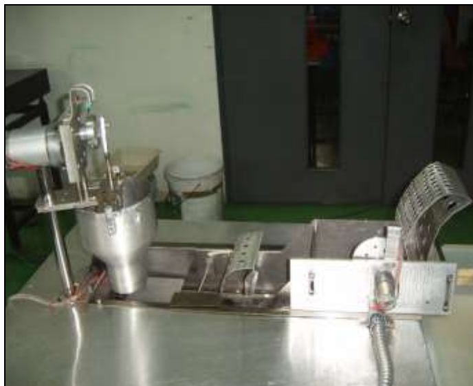
รูปที่ 3.3 ส่วนประกอบของเครื่องที่สัมผัสกับอาหารสร้างด้วยสแตนเลส เกรด 304
