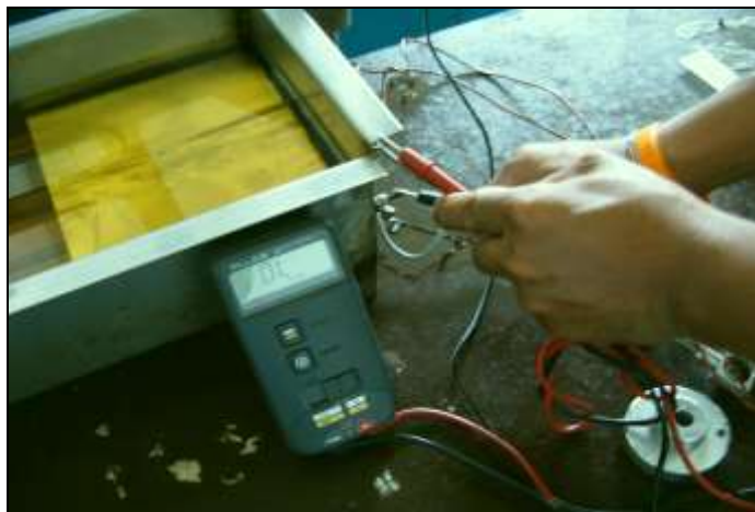
รูปที่ 3.10 แสดงการทดสอบการรั่วของไฟฟ้าระหว่างติดตั้งฮีตเตอร์
