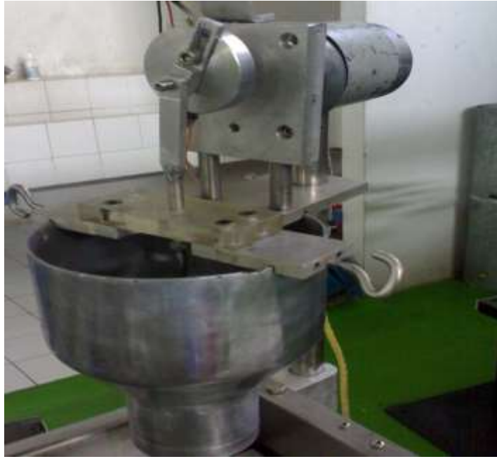
รูปที่ 3.12 ชุดหัวหยอดแป้งที่สร้างขึ้นใหม่มีมอเตอร์เป็นต้นกำลังขับเคลื่อน
