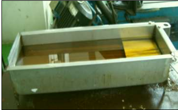
รูปที่ 3.4 หม้อทอดที่สร้างจากสแตนเลส 304
