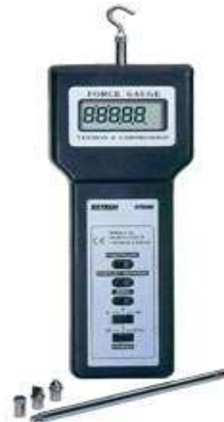
รูปที่ 3.13 อุปกรณ์วัดแรงดึงใช้วัดแรงในการหยอดแป้งขนมโดนัท
