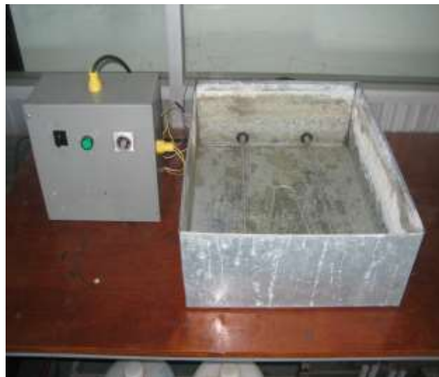
(ค) ติดตั้งตู้ควบคุมเข้ากับอ่างให้ความร้อน
