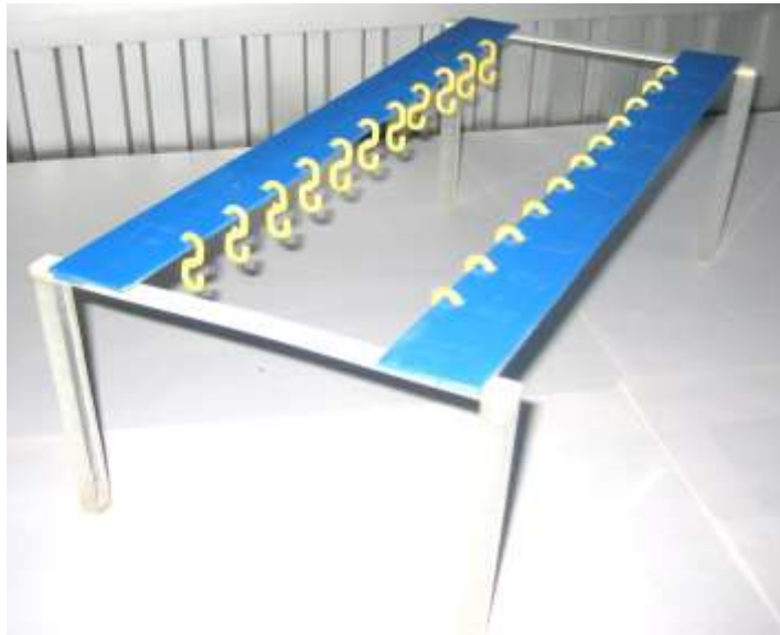
รูปที่ 3.7 ที่แขวนชิ้นงานพร้อมแหวนชิ้นงานทดสอบ
