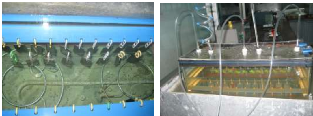
รูปที่ 3.16 การประกอบสายลมและทำการทดสอบชั้นทดสอบ
