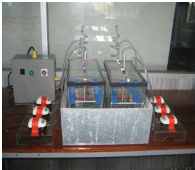
รูปที่ 3.12 ชุดควบคุมตัวแปรพร้อมทำการทดสอบที่สร้างขึ้นอ้างอิงตาม ASTM G31-72
