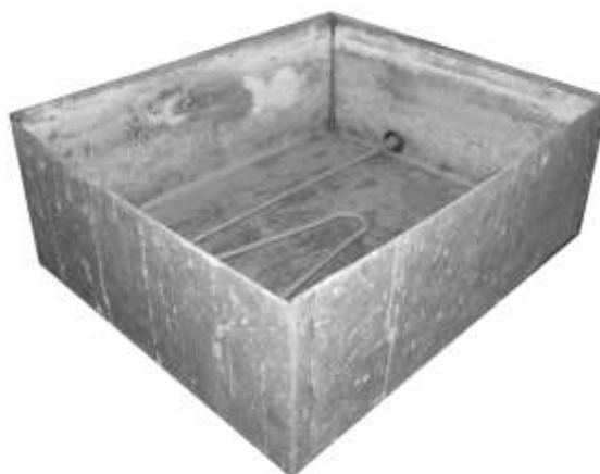
รูปที่ 3.10 อ่างให้ความร้อนที่พับขึ้นรูปและติดตั้งขดลวดให้ความร้อนเรียบร้อยแล้ว
