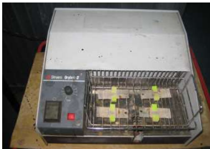
รูปที่ 3.17 การเป่าลมชิ้นทดสอบให้แห้ง
