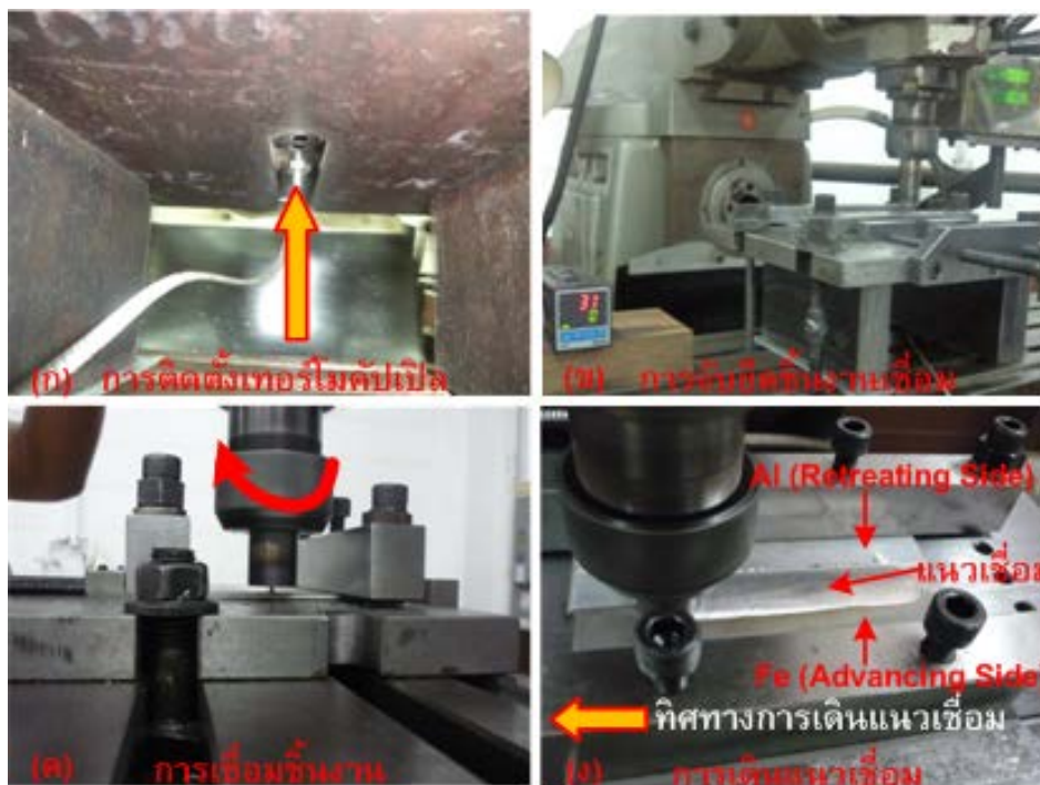
รูปที่ 3.21 แสดงขั้นตอนการเชื่อมด้วยแรงเลเซอร์แบบกวน
