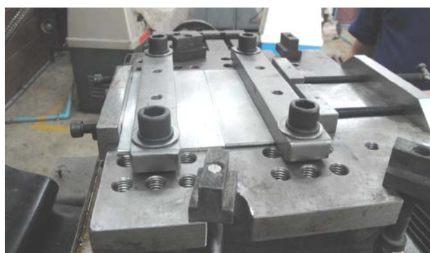
รูปที่ 3.15 การจับยึดชิ้นงาน
