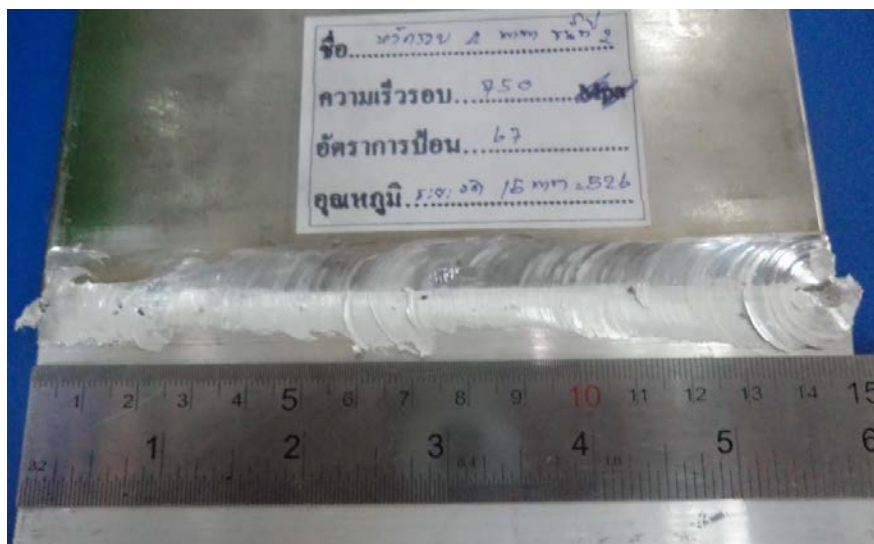
รูปที่ 3.19 ชิ้นงานที่ได้จากการเชื่อม
