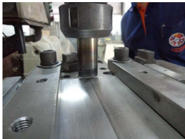
รูปที่ 3.18 เริ่มเชื่อมชิ้นงาน
