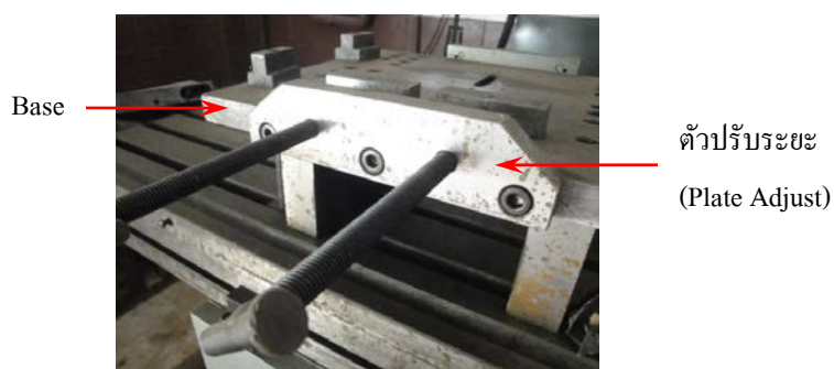
รูปที่ 3.10 การประกอบตัวปรับระยะกับแผ่นฐาน
