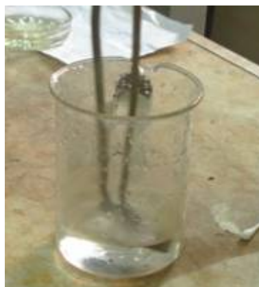
รูปที่ 3.27 การกัดกรดชิ้นงาน
