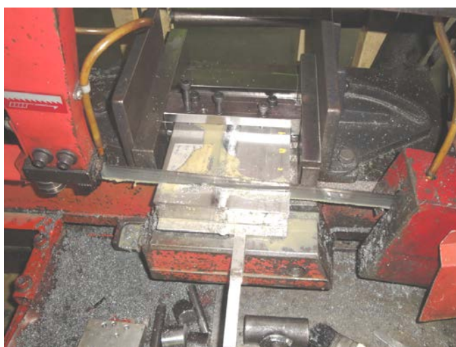
รูปที่ 3.25 ตัดแบ่งชิ้นงานเพื่อนำไปขัด
