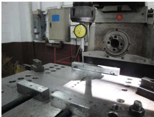
รูปที่ 3.14 ปรับแนวอุปกรณ์จับยึดชิ้นงาน
