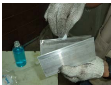
รูปที่ 3.13 ชิ้นงานอลูมิเนียม 6063 และเหล็กกล้าไร้สนิม 304
