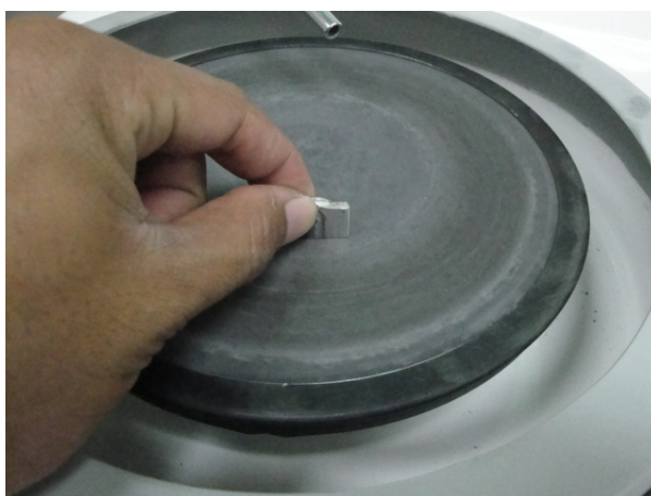
รูปที่ 3.26 วิธีการขัดชิ้นงาน
