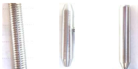
รูปที่ 3.5 เหล็ก High Speed Steel (HSS)
