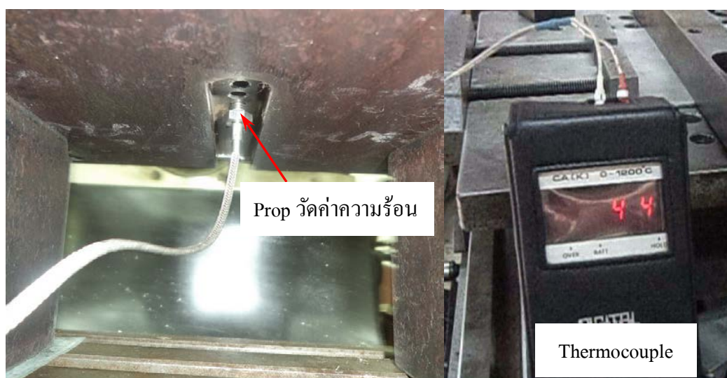
รูปที่ 3.20 การตรวจจับความร้อนด้วยเทอร์โมคัปเปิล
