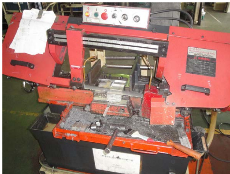
รูปที่ 3.22 แบ่งชิ้นงานทดสอบแรงดึงออกเป็นชิ้นๆ
