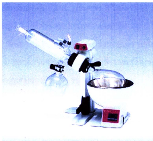
รูปที่ 3.2 การจัดตั้งอุปกรณ์สำหรับการระเหยแห้งด้วยเครื่องระเหยแห้งสุญญากาศ
