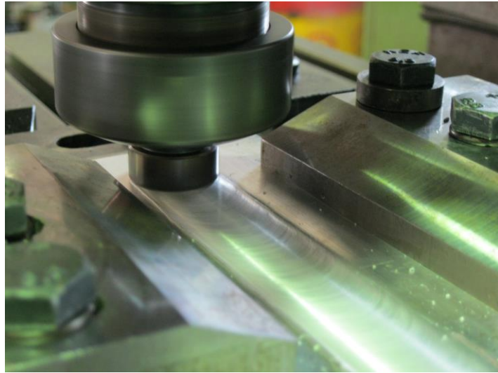
รูปที่ 3.20 การเดินแนวเชื่อมบนรอยต่ออลูมิเนียมผสม A6063
