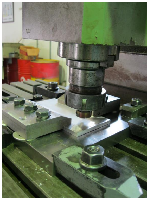
รูปที่ 3.19 การเคลื่อนที่ลงของรอยเชื่อม
