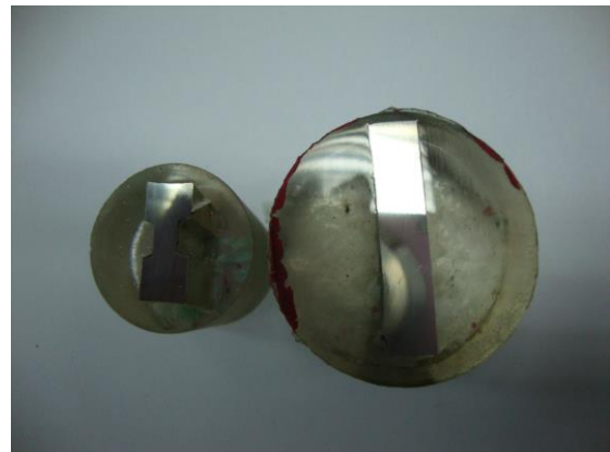
รูปที่ 3.27 ชิ้นงานที่หล่อเสร็จแล้ว [10]
