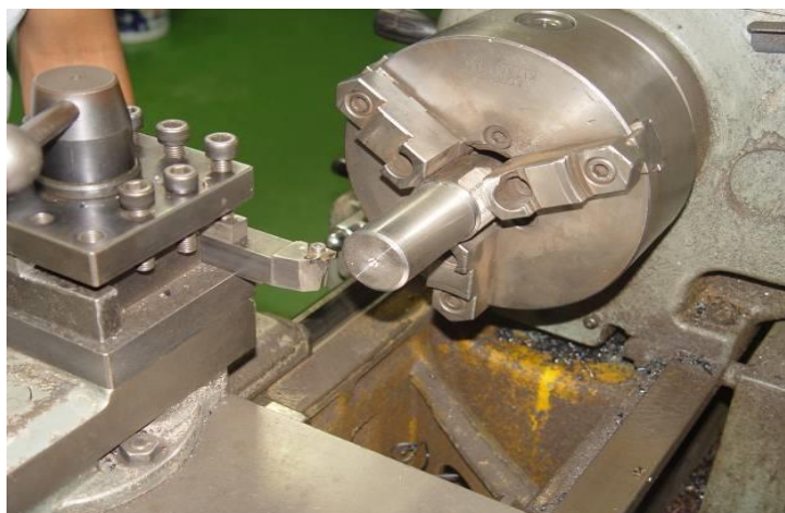
รูปที่ 3.16 การขึ้นรูปเครื่องมือเชื่อมด้วยการกลึง [10]
