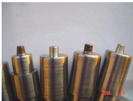
รูปที่ 2.8 เครื่องมือเชื่อมที่ออกแบบสำหรับรอยต่อชนอลูมิเนียม 2014 [23]
