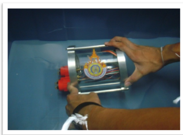
รูปที่ 4.1 การทดสอบการรั่วซึม
