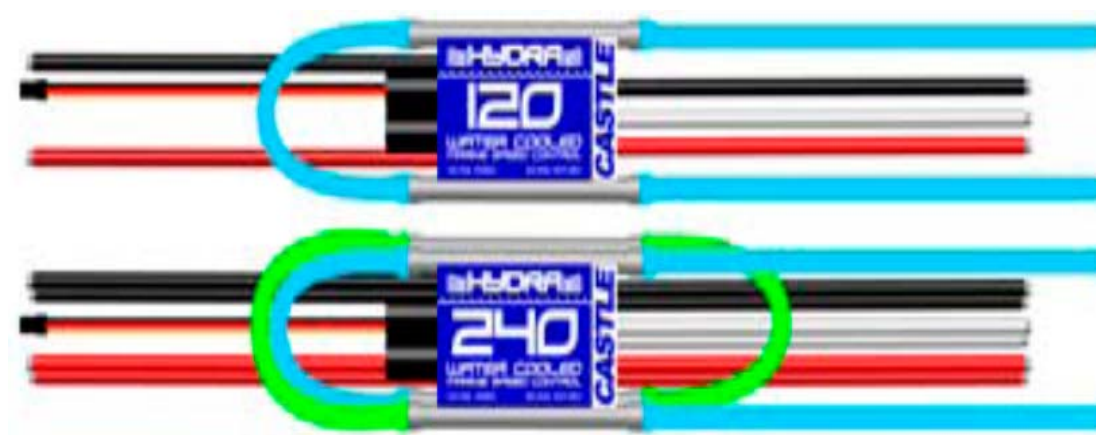
รูปที่ 3.16 ชุดควบคุมมอเตอร์ขับเคลื่อน [14]
