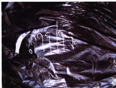
ภาพแสดงการเขียนชื่อแหล่งดินเหนียวต่างๆ ไว้ลงบนถุงภาชนะบรรจุดินเหนียว เพื่อป้องกันไม่ให้ดินเหนียวปลอมปนหรือสลับแหล่งดิน
