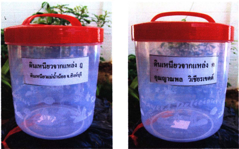
ภาพแสดงการเขียนใส่เลขรหัสดินเหนียวแหล่งต่างๆและชื่อผู้เชี่ยวชาญ ผนึกติดกำกับแบบถาวรลงบนภาชนะบรรจุดินเหนียว เพื่อป้องกันการปลอมปนหรือสลับกัน ก่อนที่จะบรรจุดินเหนียว
