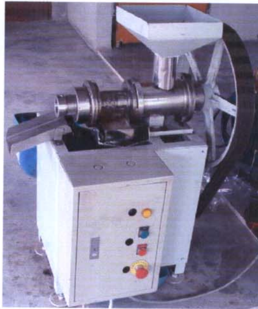
ภาพที่ 2.6 เครื่องหีบเมล็ดสับดำที่ใช้ในวิสาหกิจชุมชนพลังงานทดแทนจากสับดำ จังหวัดระยอง
