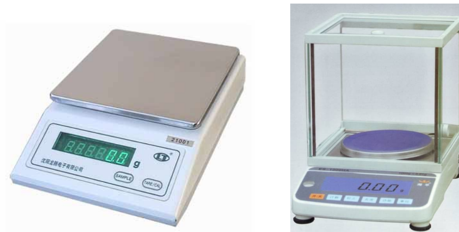
ภาพที่ ง.2 เครื่องชั่งอิเล็กทรอนิกส์แบบชั่งน้ำหนัก....ที่มีความถูกต้อง \pm 0.01 ถึง \pm 0.001 กรัม
