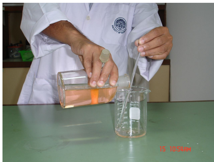
ภาพที่ ง.4 การถ่ายเทสารเคมีที่เป็นของเหลวลงสู่ภาชนะรองรับอื่น ๆ
