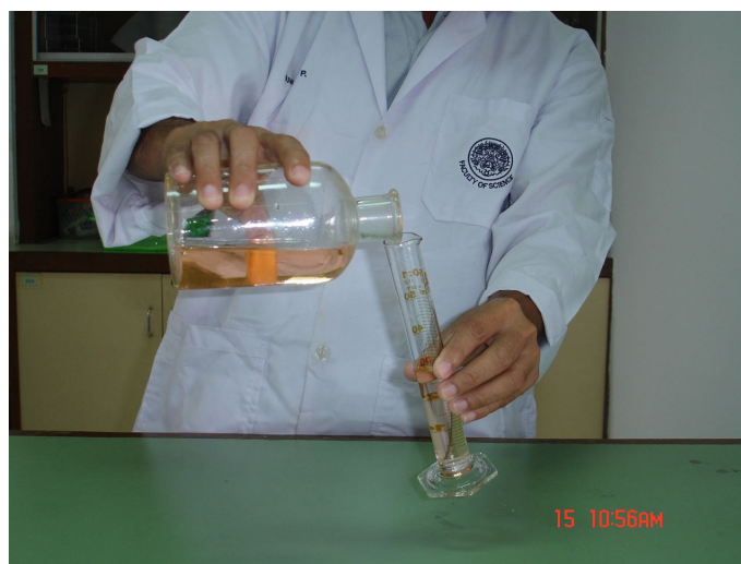
ภาพที่ ๓.7 การถ่ายเทสารเคมีจากขวดบรรจุสารลงสู่กระบอกลง
