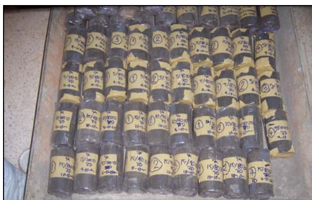
รูปที่ 3.8 การบ่มตัวอย่างดินด้วยพลาสติกเพื่อรอการทดสอบกำลังอัด
