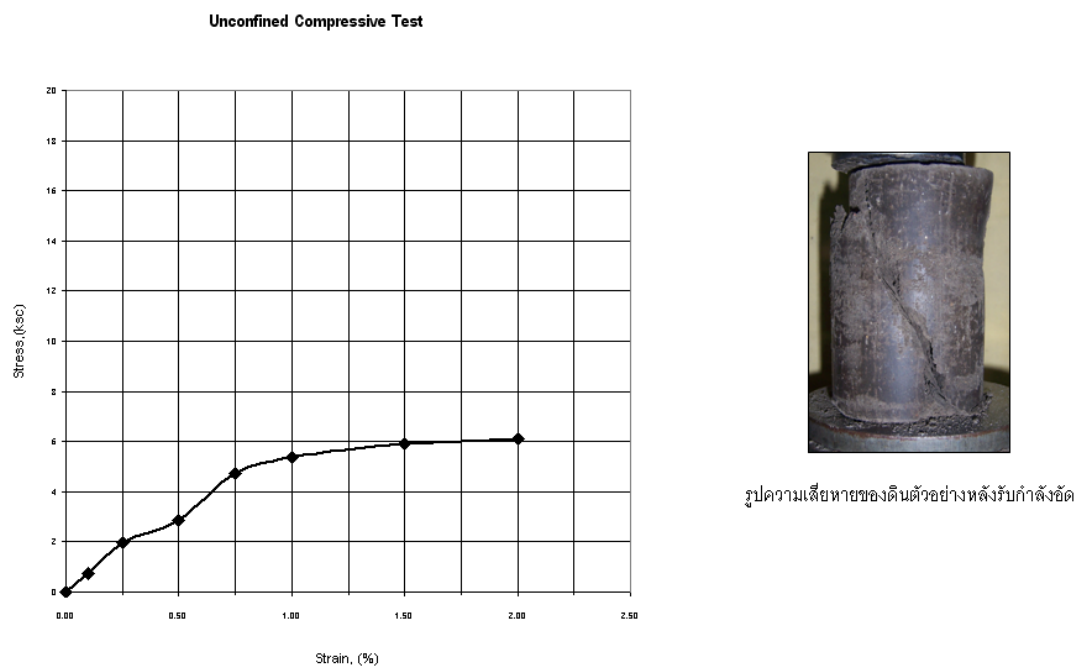
รูปที่ ข.19 ความสัมพันธ์ของค่ากำลังแรงอัดของตัวอย่างดินเหนียวที่อายุบ่ม 28 วัน ปริมาณปูนซีเมนต์ 5% ของน้ำหนักดินแห้ง โดยมีอัตราส่วนผสมระหว่าง ดินซีเมนต์ซีลเฟตกับแก้วกลบเท่ากับ 100:0
