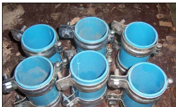
รูปที่ 3.6 แบบหล่อตัวอย่างทดสอบ PVC ขนาดเส้นผ่านศูนย์กลางภายใน 5 ซม. สูง 10 ซม.
