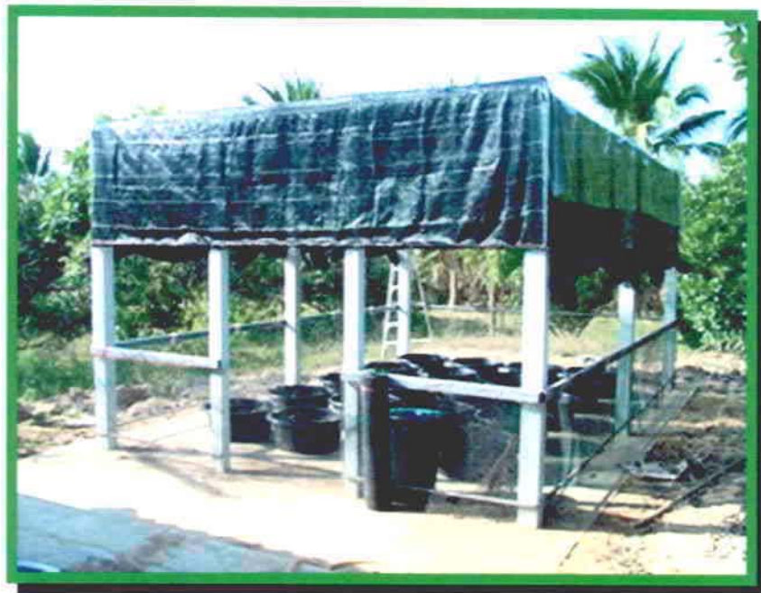
ภาพที่ ง.1 โรงเรือนทดลอง ขนาด 4.00 x 6.00 x 2.80 เมตร
