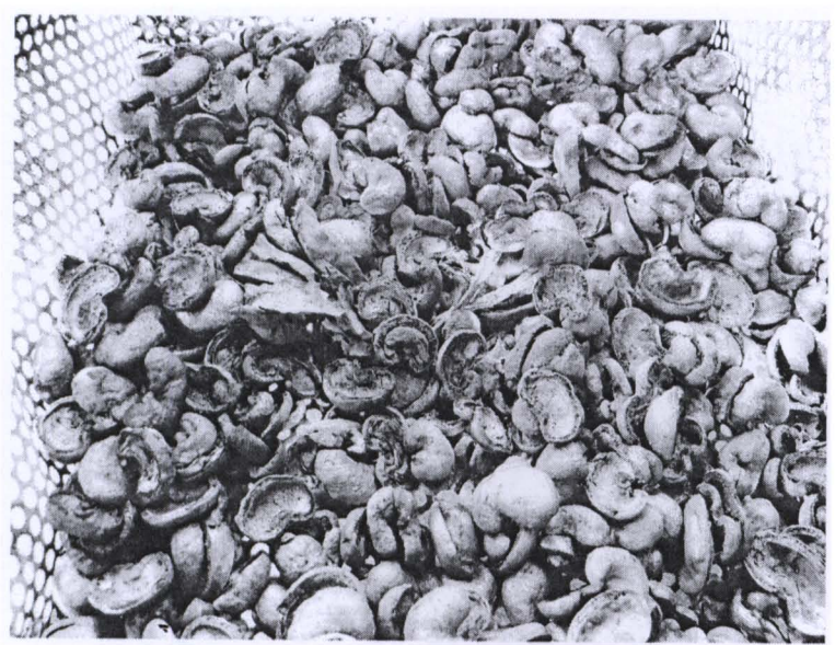
รูปที่ 58 นำตะแกรงถ่านเปลือกเมล็ดมะม่วงหิมพานต์ออกจากเตา
