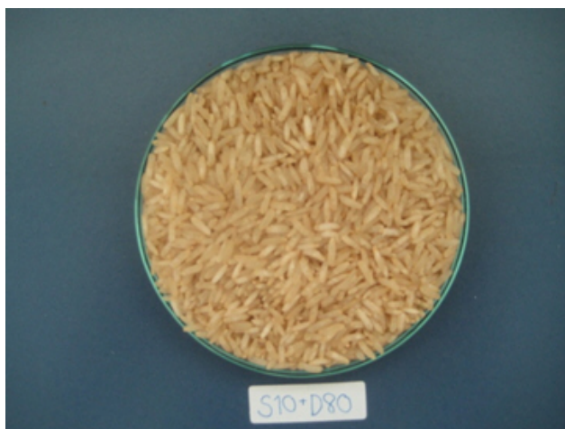
รูปที่ ก.2 ลักษณะของข้าวกล้องงอกหลังการอบแห้งที่อุณหภูมิต่างๆ โดยผ่านการให้ความร้อนด้วยไอน้ำ เวลา 10 นาที
