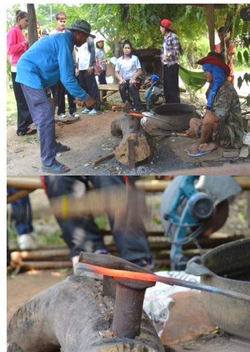
ภาพประกอบ 2 กระบวนการในการตีเหล็ก
