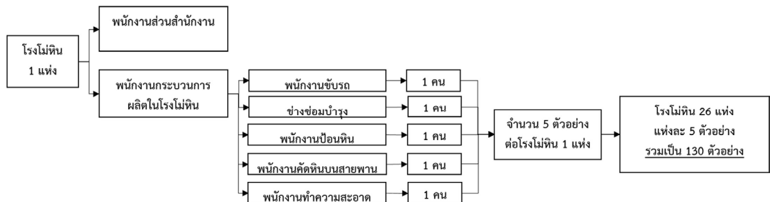
ภาพที่ 3 เทคนิคการสุ่มเก็บตัวอย่างฝุ่นละอองในโรงโม่หิน
