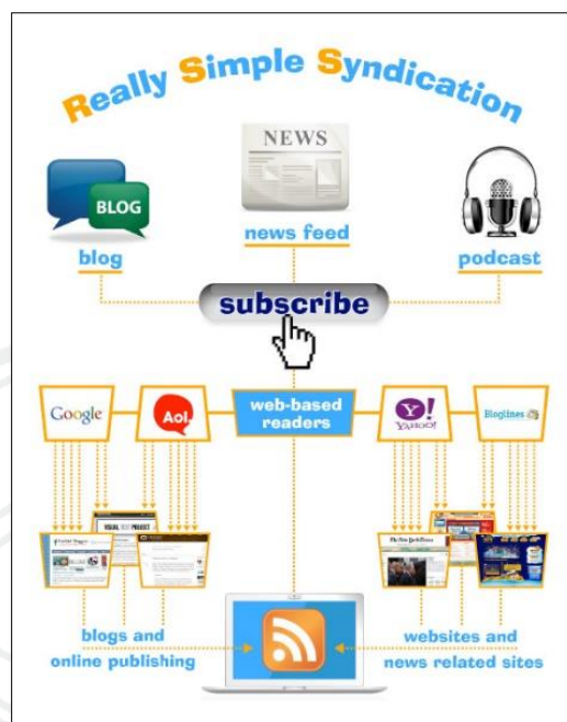
ภาพที่ 1.1 แผนภาพวิธีการทำงานของระบบ RSS
