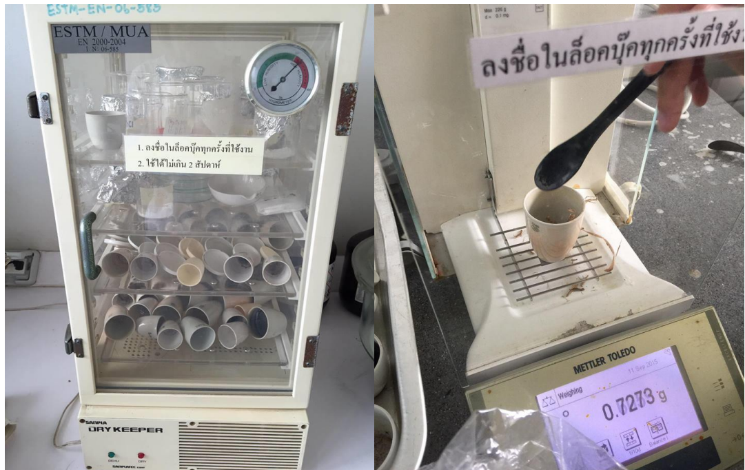
ภาพที่ ง. 7 นำถ้วย (Crusible) ใส่ในโถดูดความชื้น และชั่งน้ำหนักตัวอย่างก่อนทำการเผา
