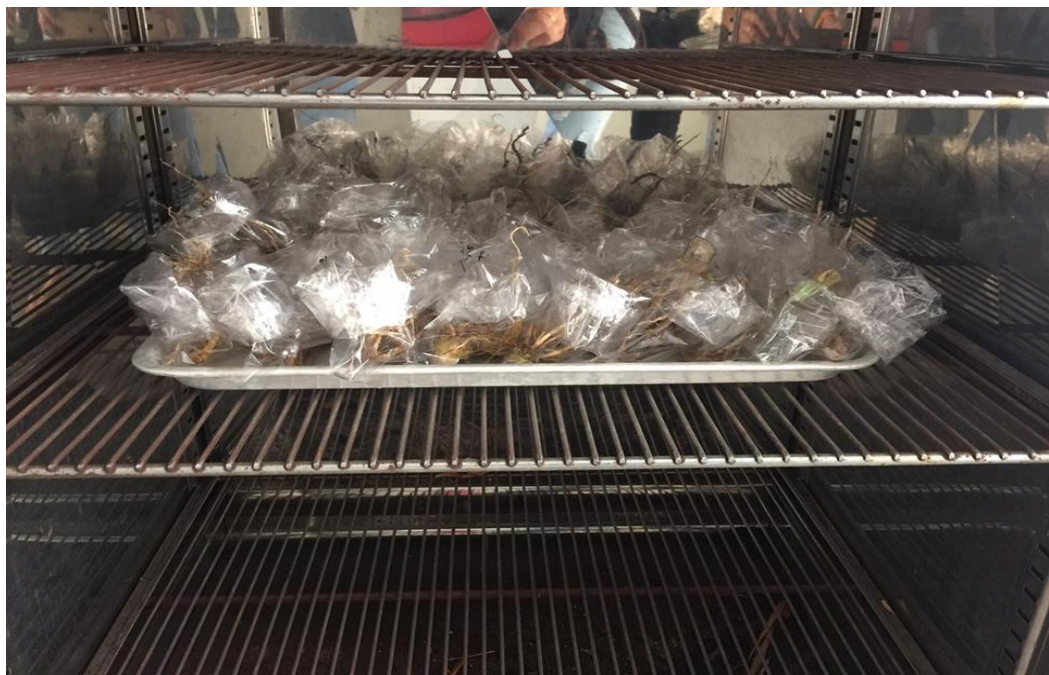
ภาพที่ ง.6 การอบตัวอย่างในตู้อบที่อุณหภูมิ 80.0 °C เป็นเวลา 48 ชั่วโมง
