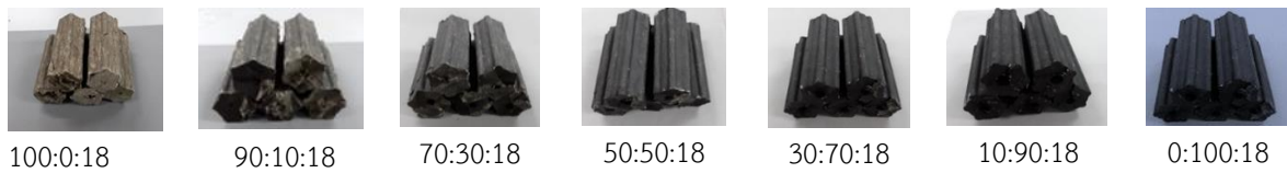
รูปที่ 4 เชื้อเพลิงอัดแท่งที่อัตราส่วนต่างๆ ที่ใช้แบ่งข้าวเจ้าเป็นตัวเชื่อมประสาน
