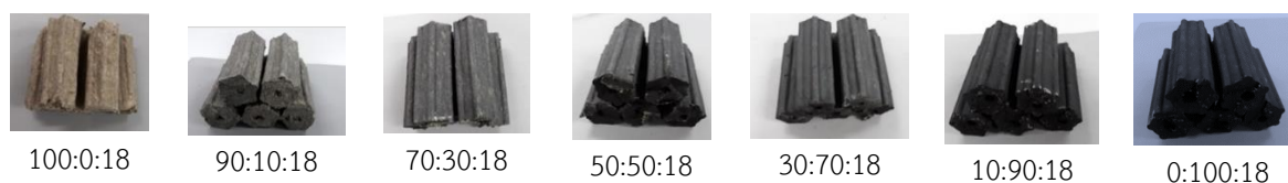
รูปที่ 3 เชื้อเพลิงอัดแท่งที่อัตราส่วนต่างๆ ที่ใช้แป้งมันสำปะหลังเป็นตัวเชื่อมประสาน
