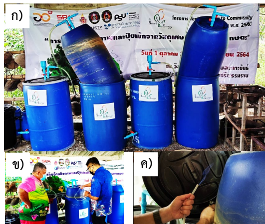
รูปที่ 5 (ก) ก๊าซชีวภาพวันที่ 15 (ข) เก็บตัวอย่างก๊าซวิเคราะห์ด้วย GC-TCD (ค) การทดสอบก๊าซจุดติดไฟ
