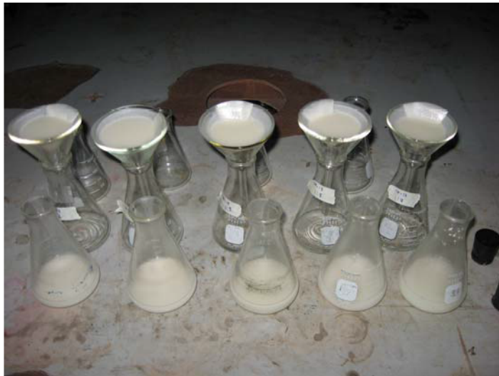
ภาพที่ 3.9 การกรองเนื้อในเมล็ดสับดูดำออกจากสารละลายด้วยกระดาษกรอง
