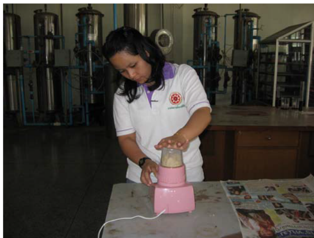
ภาพที่ 3.3 การบดเนื้อในเมล็ดสบู่ดำด้วยเครื่องปั่นน้ำผลไม้
