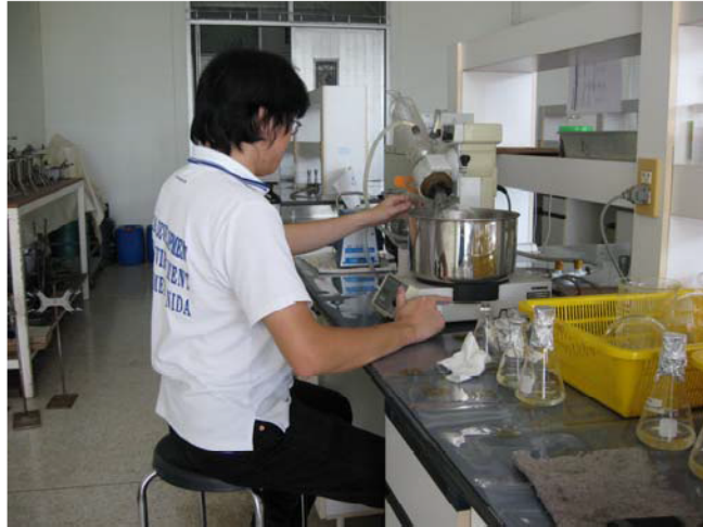
ภาพที่ 3.11 การกลั่นด้วยเครื่องกลั่นแบบโรตารี
