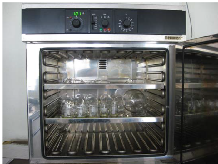
ภาพที่ 3.12 การอบด้วยตู้อบเพื่อระเหยตัวทำละลายที่ยังคงค้างอยู่ออก
