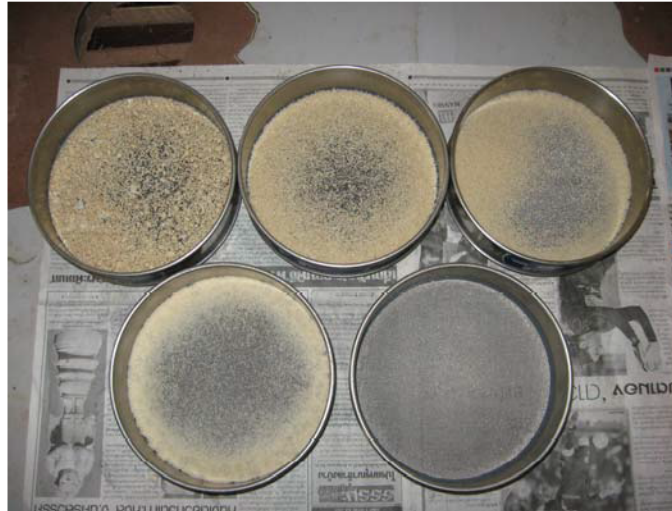
ภาพที่ 3.4 การคัดขนาดอนุภาคเนื้อในเมล็ดสับดำโดยใช้ตะแกรงร่อน
