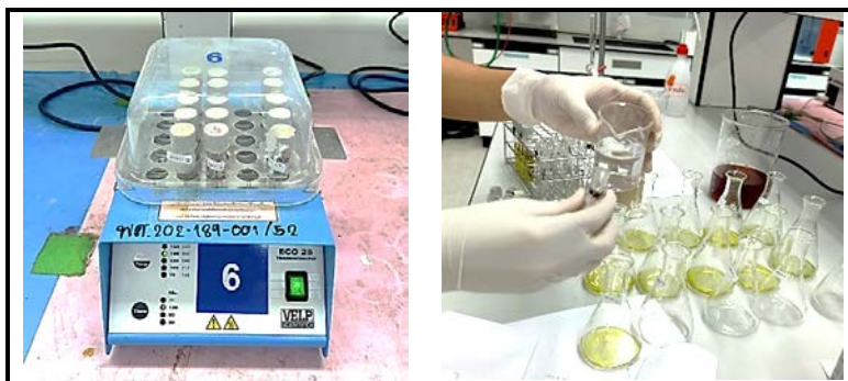
ภาพที่ 3 เครื่อง COD Reactor และ วิธีการกลั่นแบบปิด
