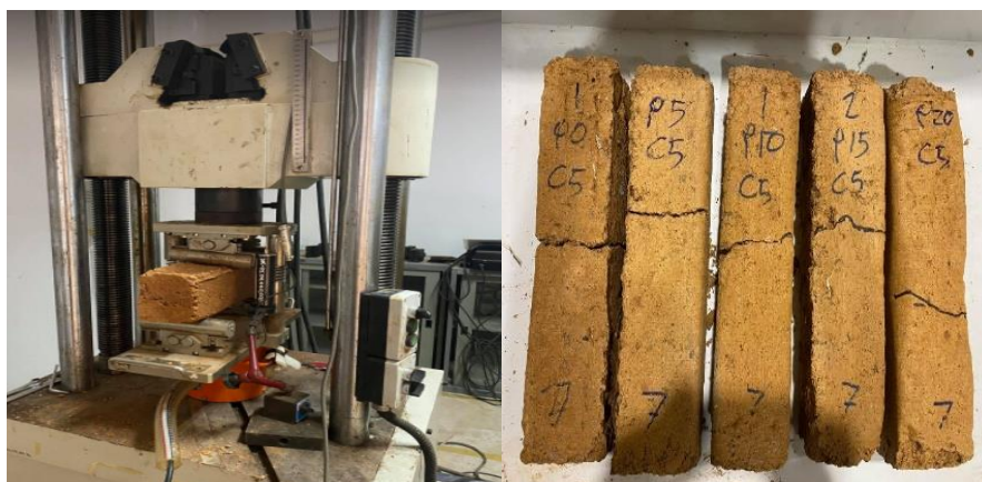
ภาพที่ 4.7 การทดสอบกำลังรับแรงดัด (Flexural strength) และตัวอย่างการทดสอบ
