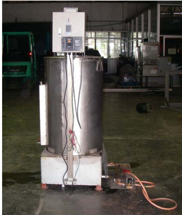
รูปที่ 3.4 เครื่องระเหยถึงสแตนเลส 2 ชั้น
