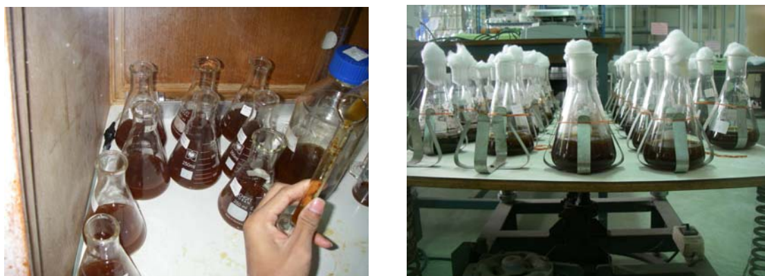
รูปที่ 3.8 การหมักเอทานอลจากสารละลายน้ำเชื่อมข้าวฟ่างหวาน
