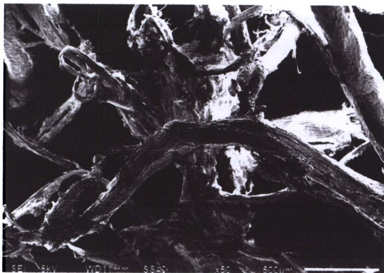
รูปที่ 4.12 ภาพขยายของเส้นใยเปลือกทุเรียนด้วยกล้อง Scanning Electron Microscope (SEM) ด้วยกำลังขยาย 50 เท่า
