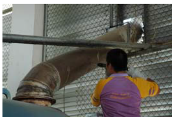
ภาพที่ 4.7 การตรวจวัดประสิทธิภาพการเผาไหม้
