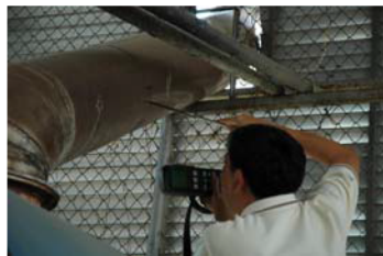
ภาพที่ 4.7 การตรวจวัดประสิทธิภาพการเผาไหม้
