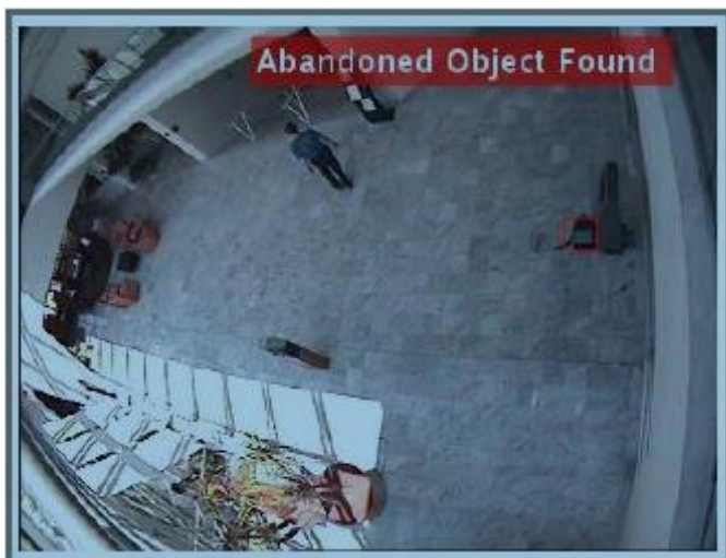
ภาพที่ 2.15 การแจ้งเตือนถูกสร้างขึ้นสำหรับวัตถุที่ถูกทิ้งและนำส่งสียบบนหน้าจอตว์ควบคุมกล้องวงจรปิด
