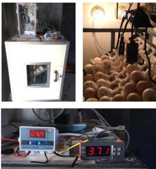
รูปที่ 2 ตู้ฟักไข่ไฟฟ้าควบคุมด้วยระบบอัตโนมัติ
