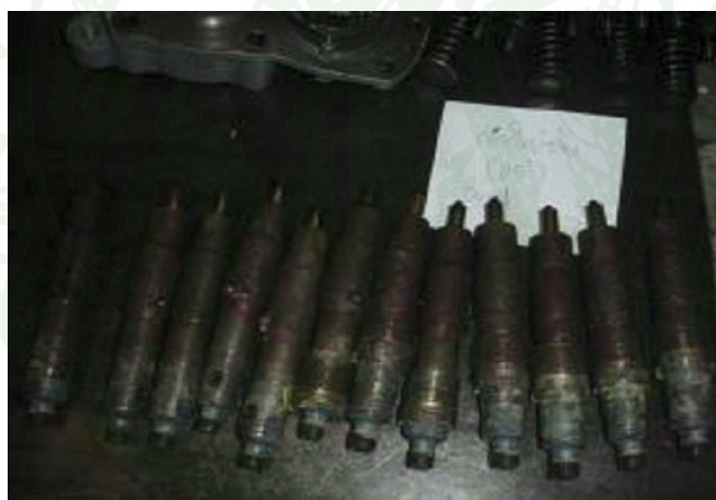
ภาพที่ 3 สภาพหัวฉีดที่ถอดออกมาพิจารณา
