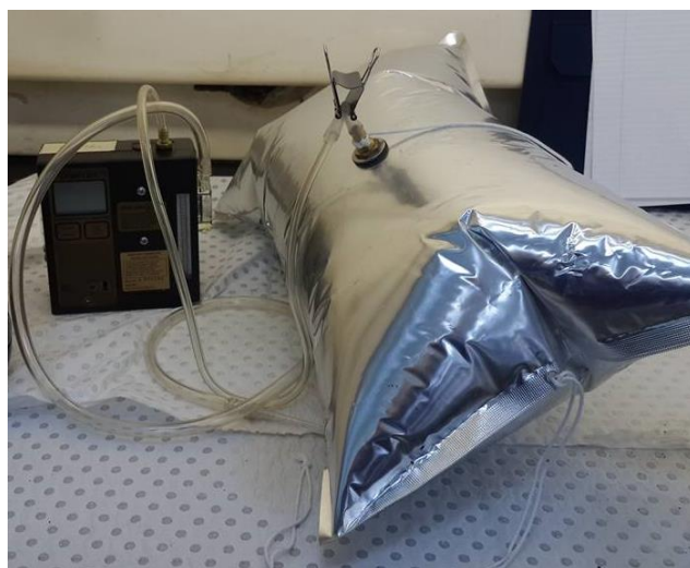
ภาพที่ 3.26 ใช้ตัวหนีบหนีบสายยางซิลิโคนของถุงเก็บอากาศ
