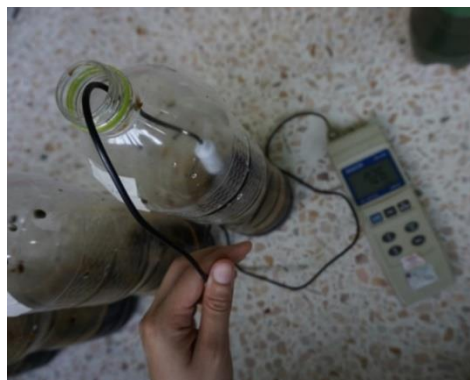
ภาพที่ 3.13 วัดค่า pH ของตัวอย่างทดลอง
