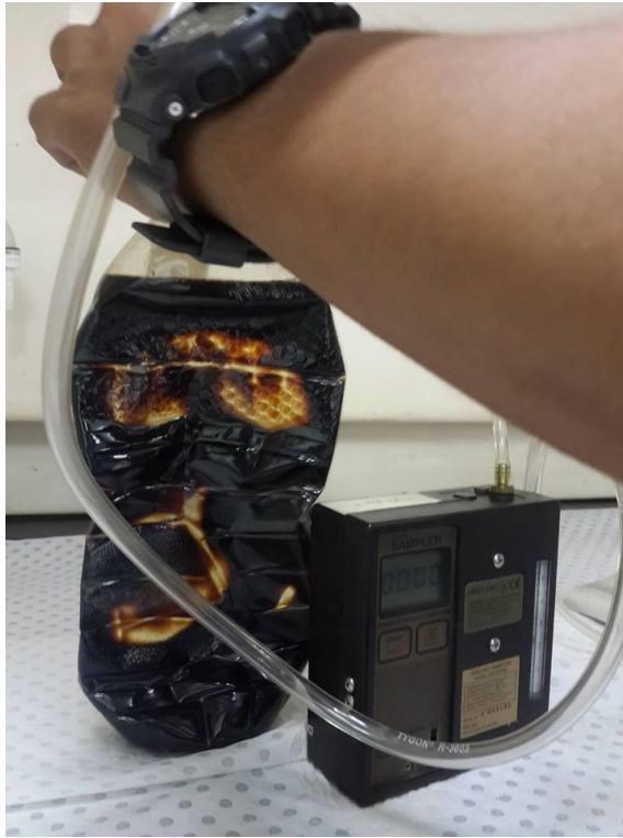
ภาพที่ 3.25 เปิดปั๊มดูดอากาศ ให้ก๊าซไหลเข้าไปยังถุงเก็บอากาศ
