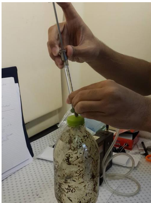
ภาพที่ 3.20 ดูดก๊าซจากขวดทดลองเข้าไซลิงค์สำหรับดูดก๊าซ
