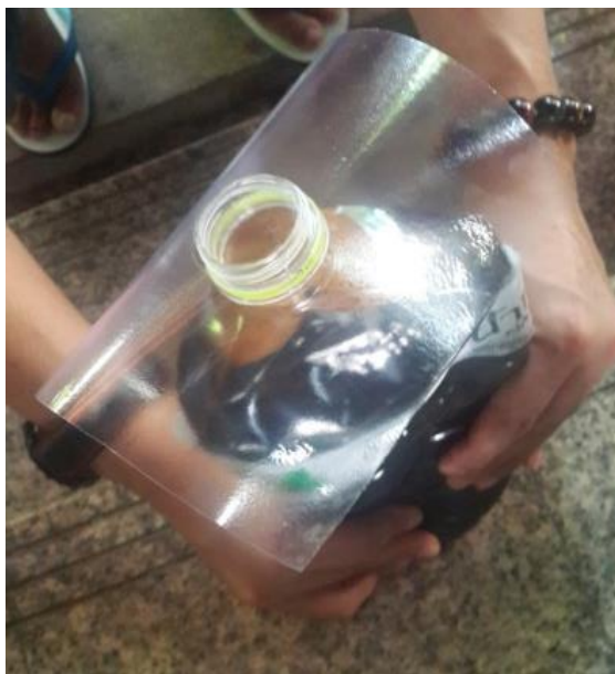
ภาพที่ 3.15 ปิดสติกเกอร์ PVC ขนาด 7x7 เซนติเมตร ลงบนปากขวด
