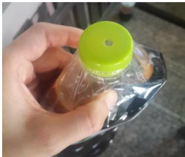
ภาพที่ 3.17 ปิดฝาขวดทดลองทับลงบนสตักเกอร์ PVC
