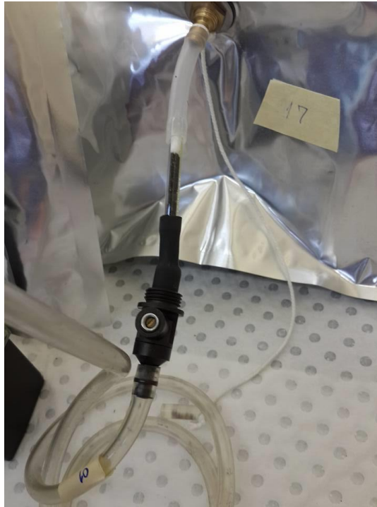
ภาพที่ 3.29 ดูดก๊าซจากถุงผ่านหลอดชาร์โคล
