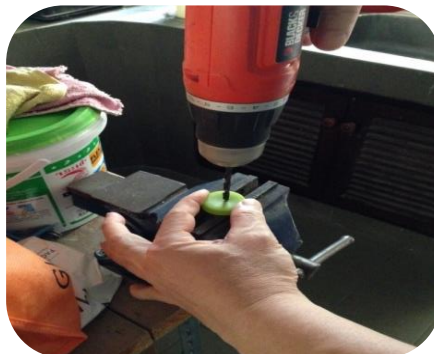
ภาพที่ 3.4 เจาะฝาขวดน้ำพลาสติกด้วยสว่าน
