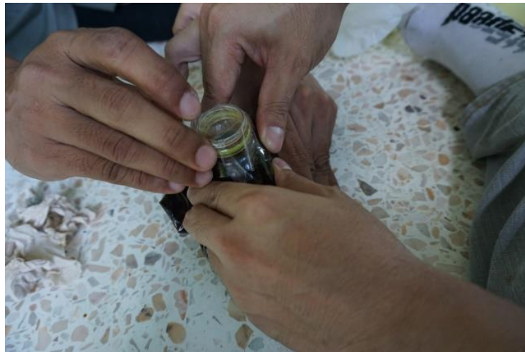
ภาพที่ 3.16 ปิดสตักเกอร์ PVC ขนาด 1.5x1.5 เซนติเมตร ลงตรงกลางปากขวด 2 ชั้น
