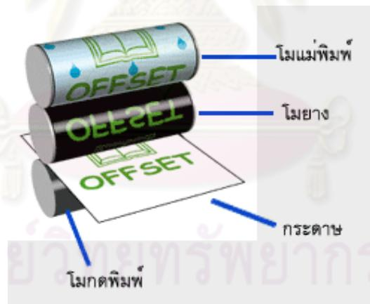
จากรูปเป็นกระบวนการเรียงพิมพ์ ตัวหนังสือ อในระบบออฟเซ็ท ที่พัฒนามาจาก
