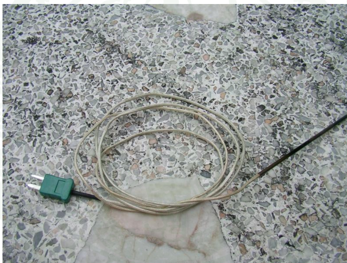
ภาพที่ 9 ตัวอย่างเทอร์มอคัปเปิล ชนิด เค
