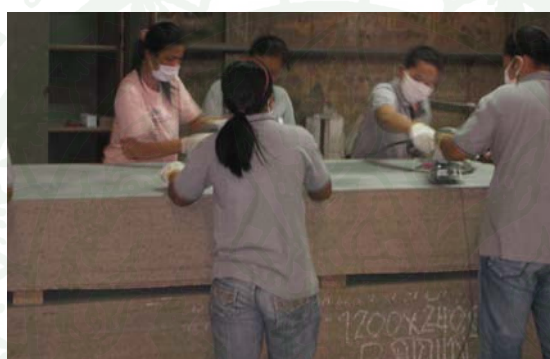
ภาพที่ 14 การตกแต่งผิวหน้าแผ่นขึ้นไม้อัดซีเมนต์
