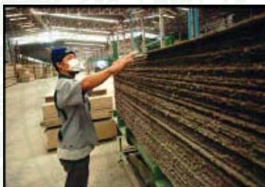
ภาพที่ 11 การเรียงซ้อนแผ่นเพื่อเตรียมเข้าเครื่องอัดเย็น
