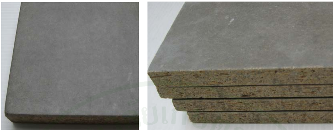
ภาพที่ 15 ลักษณะผิวหน้าและด้านข้างของแผ่นชั้นไม้อัดซีเมนต์
