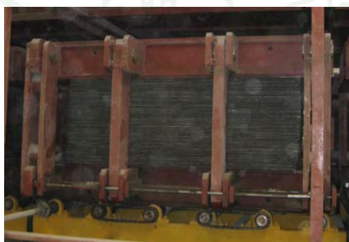
ภาพที่ 12 การอัดเย็นแผ่นชิ้นไม้อัดซีเมนต์
