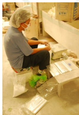
ภาพที่ 5 การชั่งตวงสารเคมีที่ใช้เพิ่มคุณสมบัติในการผลิตไม้ประกอบพลาสติก
