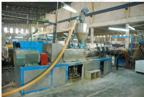
ภาพที่ 7 การขึ้นรูปผลิตภัณฑ์ไม้ประกอบพลาสติกโดยใช้ความร้อน
