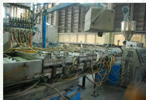
ภาพที่ 7 การขึ้นรูปผลิตภัณฑ์ไม้ประกอบพลาสติกโดยใช้ความร้อน
