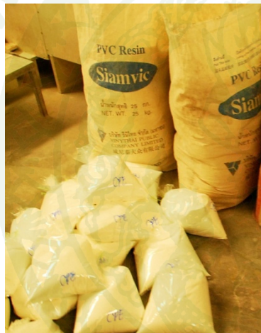
ภาพที่ 4 พลาสติกที่ใช้เป็นวัตถุดิบในการผลิตไม้ประกอบพลาสติก
