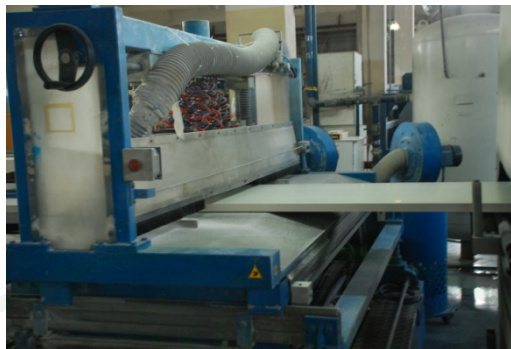
ภาพที่ 9 การใช้เครื่องจักรตัดแผ่นผลิตภัณฑ์ไม้ประกอบพลาสติก
