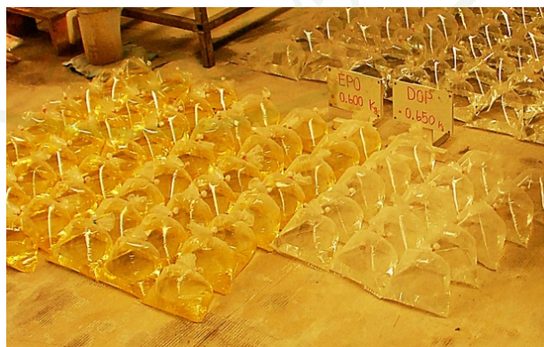
ภาพที่ 5 การชั่งตวงสารเคมีที่ใช้เพิ่มคุณสมบัติในการผลิตไม้ประกอบพลาสติก
