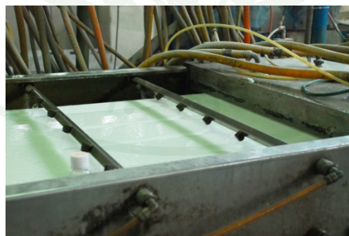
ภาพที่ 8 การทำให้ผลิตภัณฑ์ไม้ประกอบพลาสติกเย็นโดยใช้น้ำ
