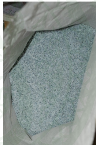
ภาพที่ 4 พลาสติกที่ใช้เป็นวัตถุดิบในการผลิตไม้ประกอบพลาสติก
