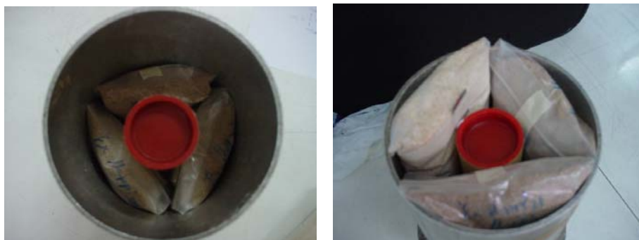
ภาพที่ 7 ขนาดของตัวอย่าง ตำแหน่งการวางตัวอย่างและการติด dosimeter
